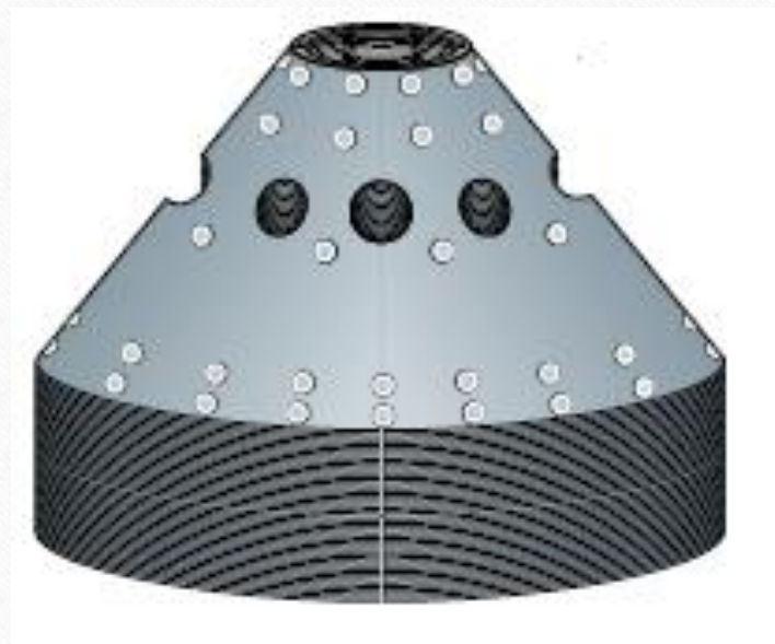
Konusni disk sa distribucionim otvorima i zaptivačima
